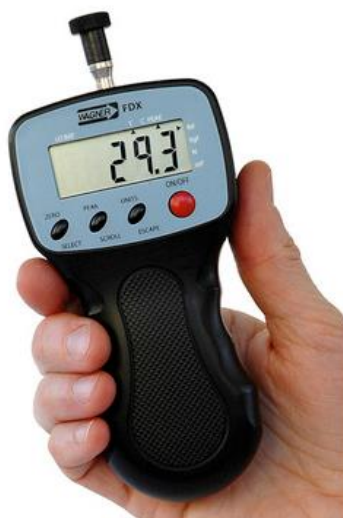
Рисунок 1. Цифровой альгометр, модель FDX 50, фирма-производитель Wagner Instruments (США), единица измерения – Ньютон (N).
